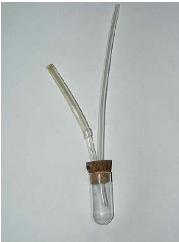
Obrázok 17 Exhaustor pre individuálny odchyt strapiek (foto: R. Masarovič, 2007).
